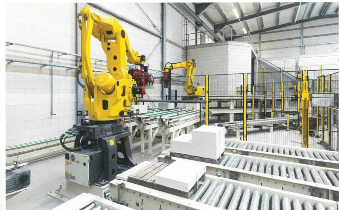
In einem halb-beziehungsweise vollautomatisierten Prozess werden die Mauerwerkswände mit höchster Präzision gefertigt
